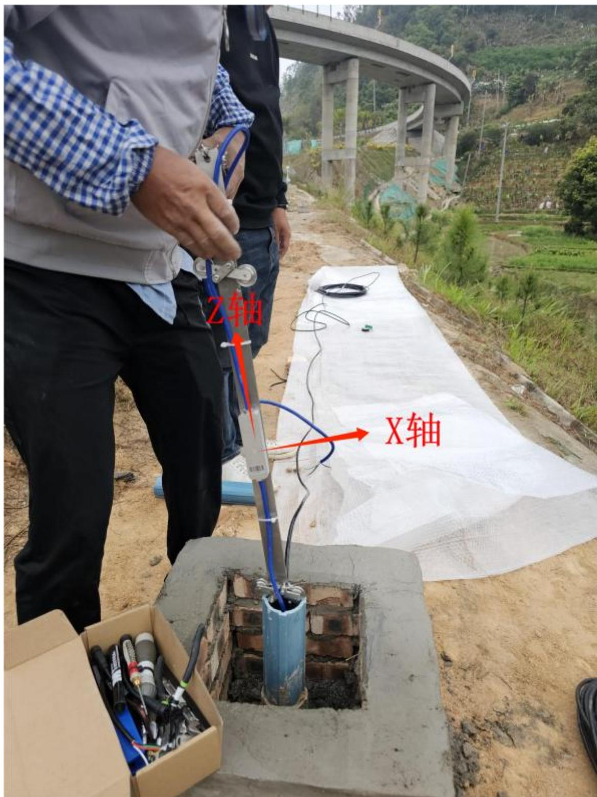
步骤 3：固定式测斜仪全部下放完毕后，将上盖与测斜管固定，管口处用螺丝锁紧。
