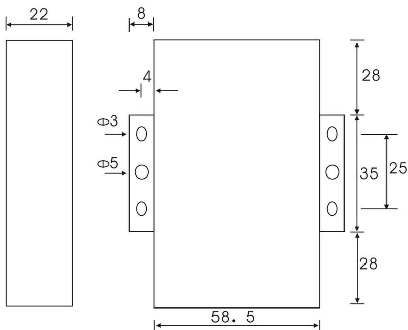
图 6-1 安装指示图
