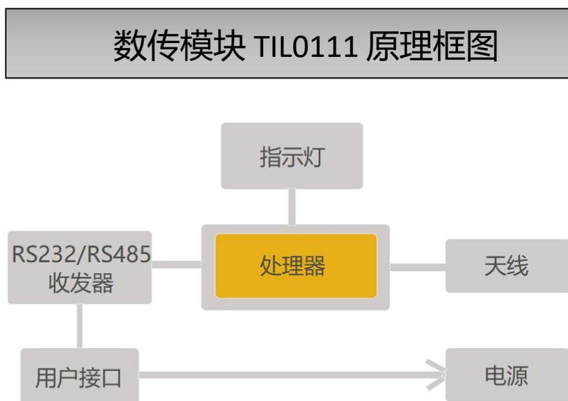
图 4-1 TIL0111 结构框图
