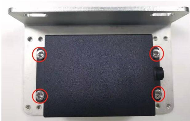
6) 接下来用螺丝穿过支架上预留的螺丝孔紧紧把支架锁住在前面打孔的位置。
