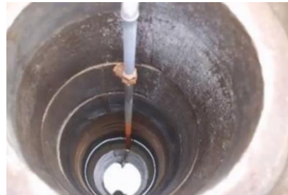
深井、基坑水位监测
