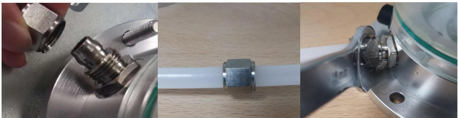
2) 各个设备的通液口利用通液管相互连接起来，首尾设备外侧通液口接头换成一字堵头。
